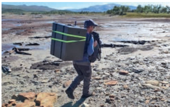
En laserskanner har mye sensitiv elektronikk, og en spesialtilpasset bæreanordning må benyttes for å få utstyret frem. Foto: David B. Tuddenham, Trøndelag fylkeskommune
