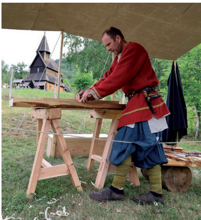
Høvelbenken som benyttes i rekonstruksjonsarbeidet, er en rekonstruksjon av en arbeidsbenk fra middelalder. Illustrasjoner og arkeologiske funn ligger til grunn. I og med at gulvene i middelalder ikke var flate, har benken tre føtter – og vil dermed stå stødig også på ujevnt underlag. Foto: Mona Sand
