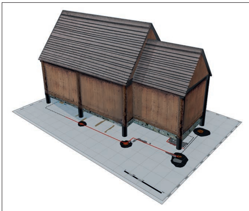
Prinsippskisse for stavkirkekonstruksjon, a) med jordgravde staver/stolper, og b) med stav/stolpe stående på bakken vist over fotavtrykket til de første to kirkebyggene. I begge konstruksjoner er svillen sammenføyet med staven. 3D-modell: NIKU med tilpassinger av arkitekt Marit Sørungård
