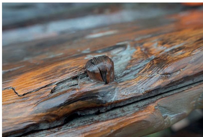
Til venstre: Utsnitt av babord side mellom band 5 (til høyre i bildet) og 6, viser trenaglene som er brukt for å feste sammen bordgangene. Foto: Fredrik Skoglund, NTNU Vitenskapsmuseet
