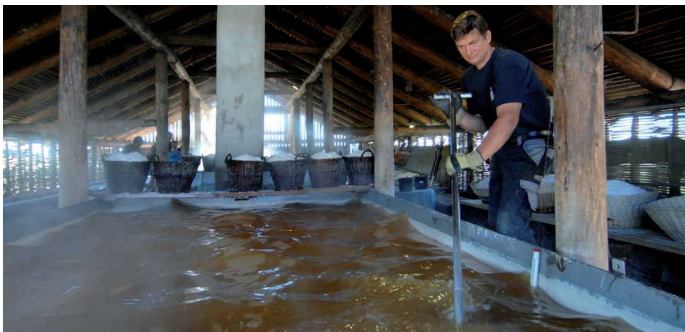
Saltsydehytte på Læsø i Danmark. Saltkjelen midt i bildet har stor fordampingsoverflate. Foto: Læsø Salt A/S
