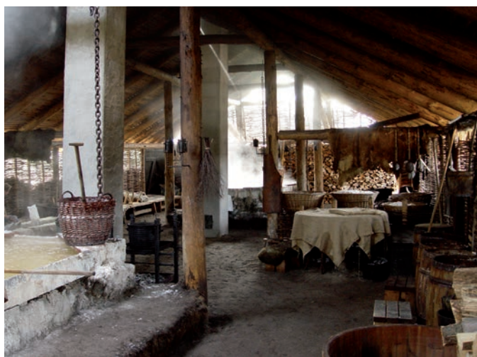
Saltsydehytte på Læsø i Danmark. Rundt Læsø inneholder sjøvannet cirka 2 % salt, men grunnvannet på Rønnerne inne på øya kan inneholde helt opptil 14 % salt. Foto: Læsø Salt A/S
