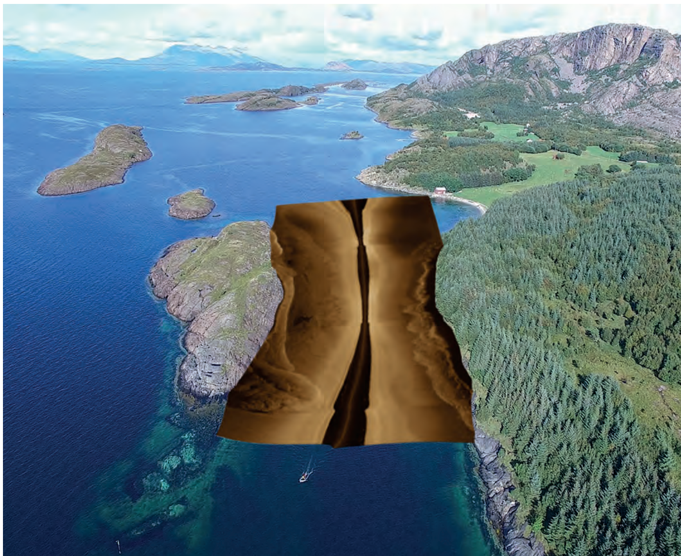
Fotomontasje med dronefoto over Hamnsundet rett nord for Esøya. Nederst i forkant sees gummibåten som trekker den sidesøkende sonaren. Påmontert er sonarbildet fra denne delen av Hamnsundet, dvs. mellom Hamnøya (til høyre i bildet), og Storkiskjæret (til venstre). Foto og illustrasjon: Fredrik Skoglund, NTNU Vitenskapsmuseet
