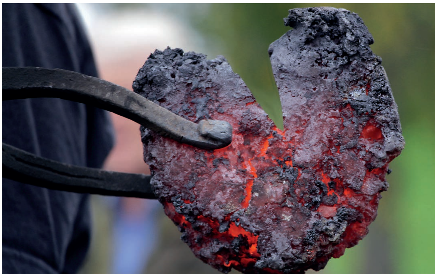
En ennå varm jernlupp etter første komprimering og kløyving med øks. Det siste gjøres for å se hvor kompakt den er, og om den tåler å kløyves uten å fragmenteres. Denne bestod testen med glans, og vi har en kompakt lupp med det som trolig er godt smibart jern. Foto: Per Steinar Brevik
