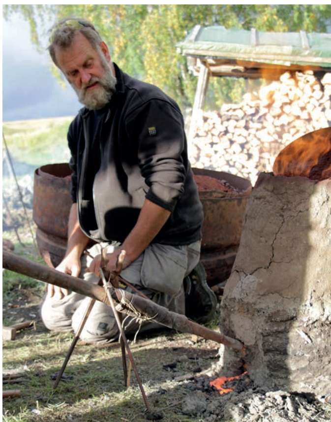
Jens Jørgen Olesen er fornøyd med testovnen. Lettflytende slagge kommer rennende ut. Foto: Per Steinar Brevik
