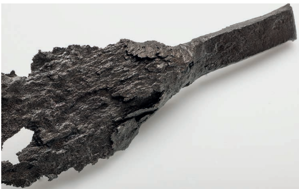
Sammenbrettingen gjorde at sveisingen fra vikingtiden gikk opp og viste oss produksjonsmetoden. Foto Åge Hojem, NTNU Vitenskapsmuseet
