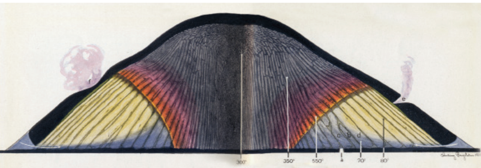
Prinsippskisse som viser hvordan forkullingssonen brer seg fra kjernen til ytterkantene av ei reismile. Temperaturen i mila er høyest i forkullingssonen. I midten ligger det ferdige trekullet. Hastigheten på forkullingsprosessen og hvordan den brer seg i mila kan styre ved hjelp av luftekanaler i miledekket.
