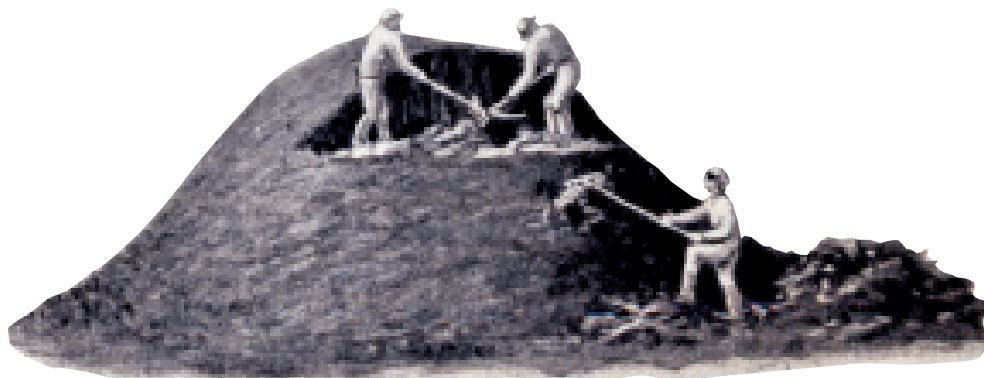
Med river og kullkroker tas trekullet ut fra ei reismile etter at kullbrenningen er ferdig.
