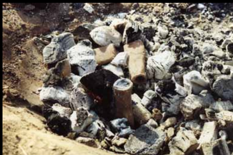
To støpeformer i støpegropen med det glødende trekullet. I den nærmeste er det allerede støpt. Bronsen ses som en grå, rynket overflate i toppen av støpeformen. Slik blir metallet når det størkner i luft.
