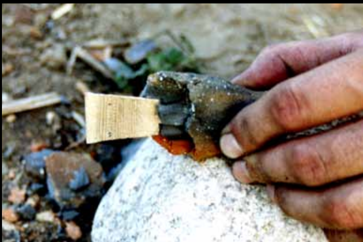
Leirformen slås i stykker. Det nystøpte metallet er gult og glatt fordi det er størknet uten påvirkning av oksygen. Det trenger kun litt pussing og fjerning av innløpet.
