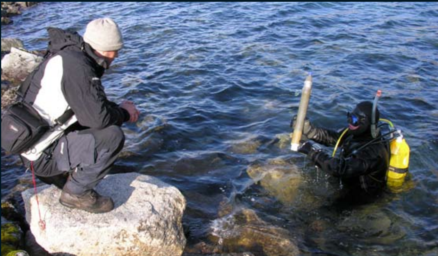
Glødetapsprøven ble tatt fra 15 meters dyp. Foto Dag Ringstad
