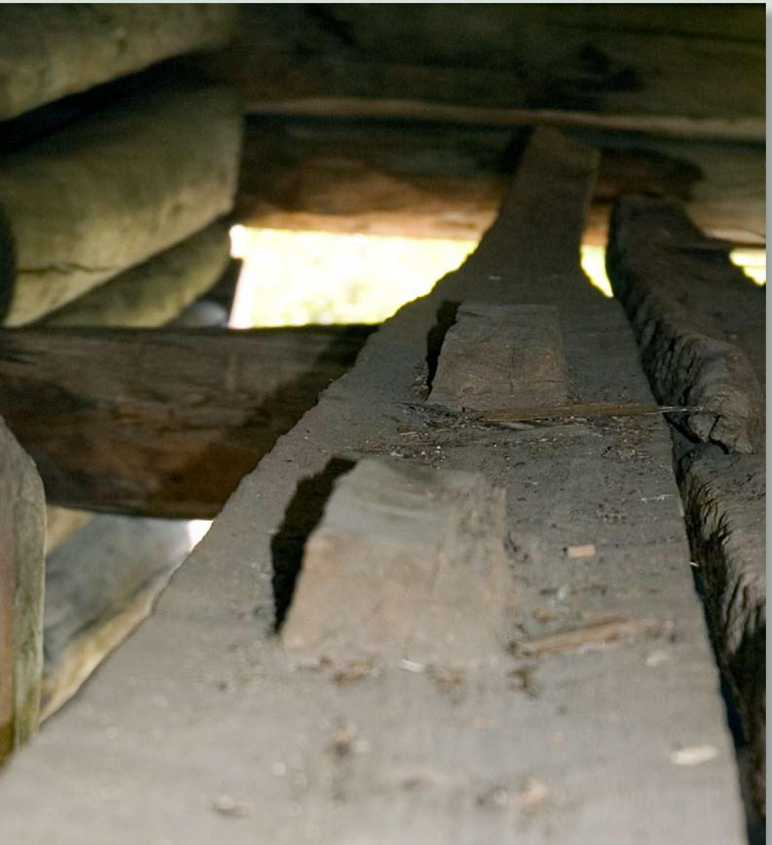
Detalj av båtkjølen. I surringsklampene som sees på kjølen overside, ble det boret hull for feste av båtens band (spant). Foto Morten Sylvester
