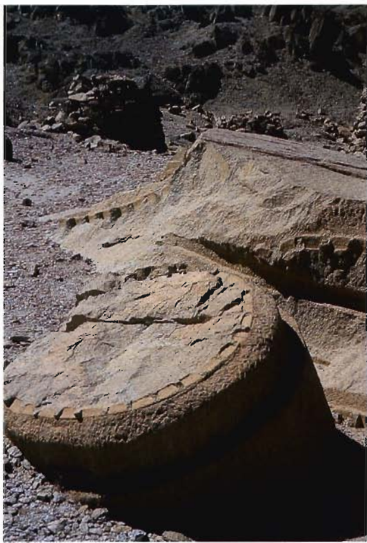
Romernes viktigste brytningsteknikk i Østørkenen var kilespalting. Teknikken ble også benyttet for å spalte halvferdige objekter. Her ser vi fine kilehull brukt for å dele en søylestump i Mons Claudianus.
