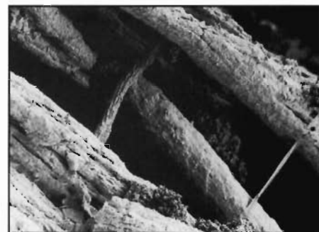
Bilde av fibrene i Finstad-tekstilet tatt gjennom et scanningelectron-mikroskop. Mineraliseringsprosessen kom ikke fort nok i gang før forråtnelsesprosessen begynte å bryte ned ull-fibrene. Bare fiberen lengst inne på fotomikrografiet viser den karakteristiske skjell-strukturen som er et kjennetegn for ull. Foto: E.E. Peacock
