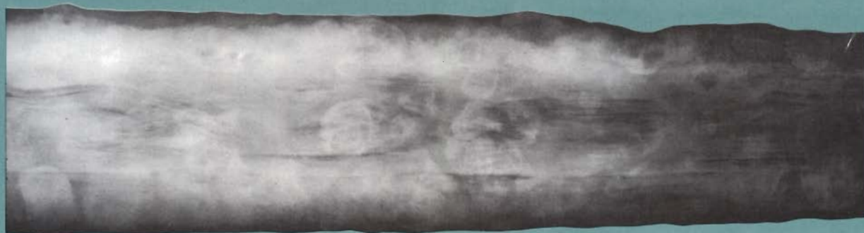
Röntgenbilde som viser en del av klingen på et sverd fra Egge, Steinkjer. Bølgende stålstriper former et mønster som ligner en løssnodd flette. Sverdet stammer fra 900-tallet.
