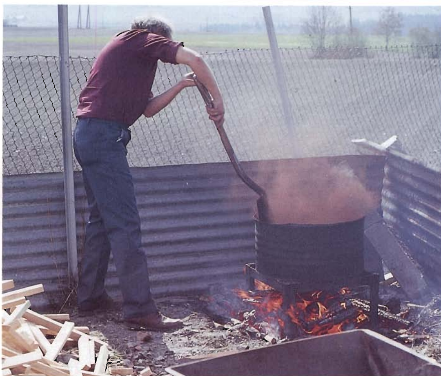
Er det dugurdsgrauten som blir klargjort for arbeidsgjengen? Nei, her er det malmen som blir røsta og som gir frå seg damp - i eit avsagd oljefat!
