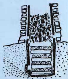
b. Røstet malm blir tilsatt. Ovnen etterfylles med trekol. Så blir malm og trekol satt til vekselvis. Tegningen viser starten på reduksjonsprosessen.
