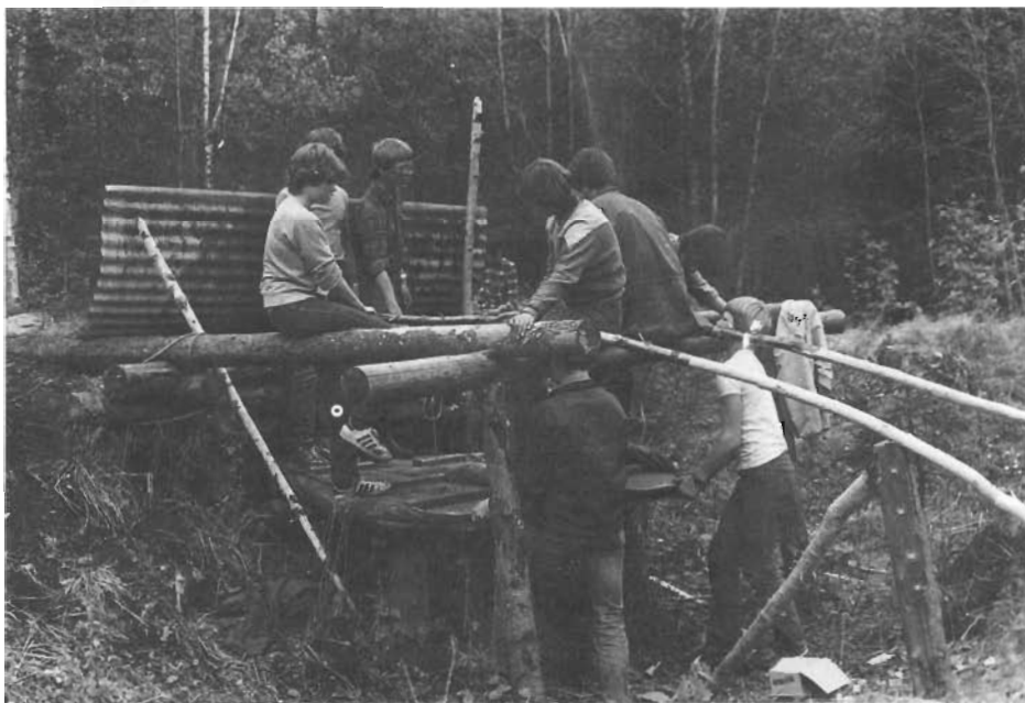
Malmen blir lagt på trekolet og belgtrødarane går til aksjon. No er det viktig å få ein' jamn og høveleg stor tilgang på luft.
