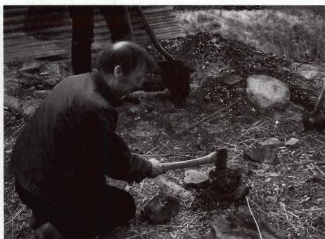
Eit kraftig hogg gjennom "luppen" viser at det er godt smibart jarn som har blitt produsert.
